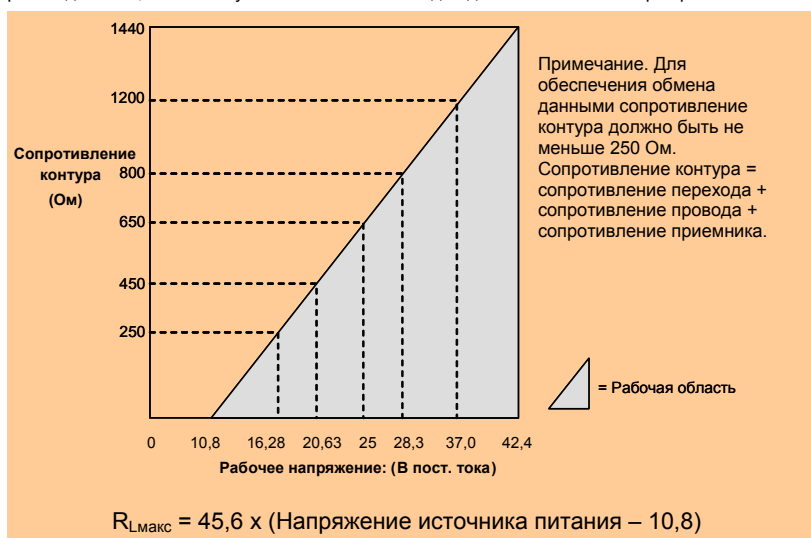
Рисунок 2. График и расчеты зависимости сопротивления контура от напряжения питания
